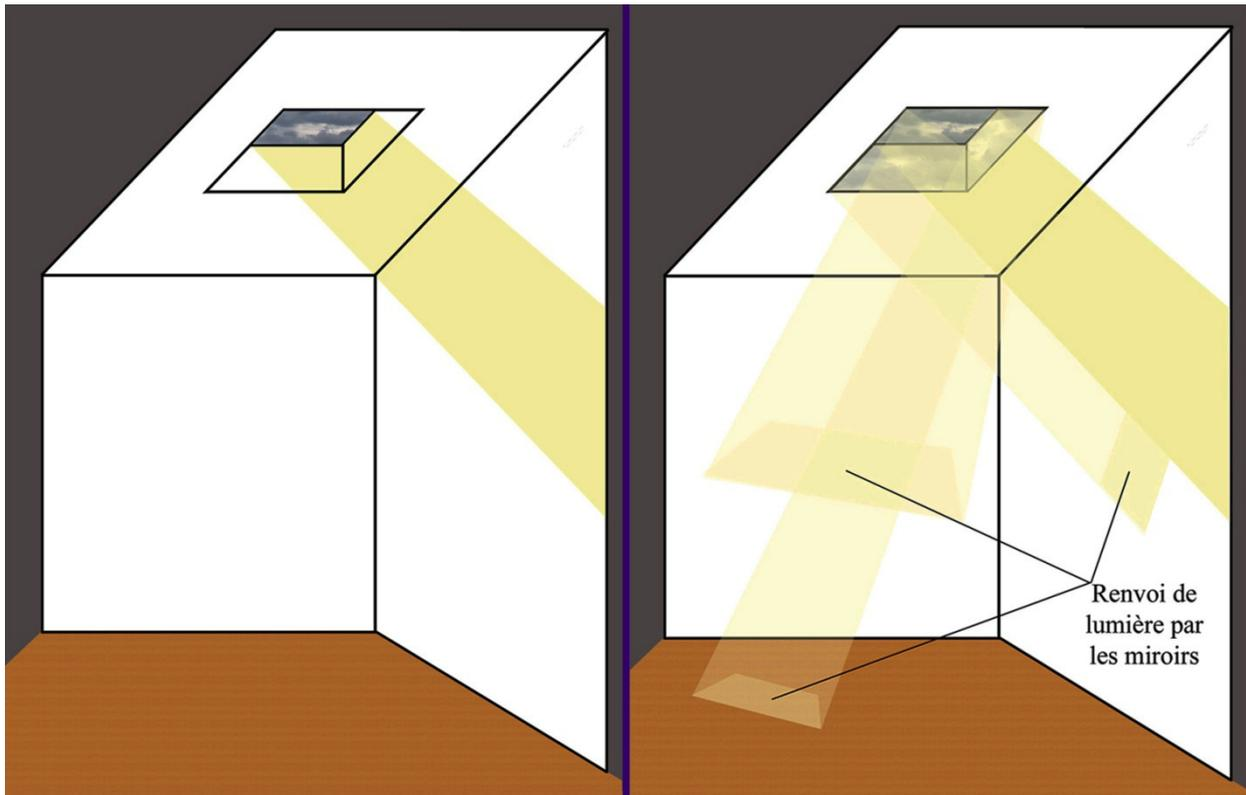
« Se composant de surfaces réfléchissantes installées de chaque côté d'une ouverture de maison, le concept dit « Entourage d'ouverture miroir » a pour but de renvoyer la lumière/luminosité projetée par le soleil/ciel sur la tranche de mur entourant une ouverture (notamment des fenêtres) vers l'intérieur de la pièce
